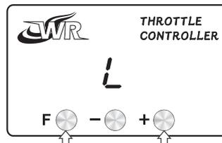
重新匹配：已經完成匹配的機器，必須在按住 F 鍵與 + 鍵的狀態下通電，螢幕會顯示 4、3、2、1、0 倒數，倒數結束後進入匹配模式。
