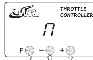
刪除已匹配資料：按住 F 鍵和 - 鍵和 + 鍵後通電，螢幕會顯示 4、3、2、1、0 倒數，倒數結束後進入匹配功能並刪除先前的匹配資料。若只想刪除先前的匹配資料，此時可短按 - 鍵或 + 鍵退出匹配模式。
