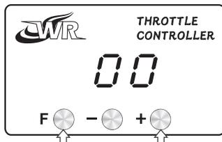
安裝匹配：汽車熄火未通電螢幕無任何顯示時，同時長按 F 鍵與 + 鍵不放，開啟電門ACC(不發動車子)，直到螢幕顯示「L」後放開按鍵，並放開油門。接著短按 F 鍵(此時不可踩油門)，2秒後螢幕顯示「H」，此時將油門踩到底且保持不放，再次短按 F 鍵(油門不能鬆開)，2秒後螢幕顯示匹配結果，「00」，表示匹配成功，此時即可放開油門。匹配結果顯示3秒後，將自動進入正常顯示狀態。
