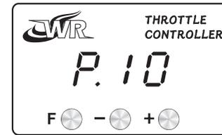
一鍵加速：正常運行時，長按 F 鍵可啟動一鍵加速(進入一鍵加速後，螢幕會顯示倒數 10 秒，倒數結束後自動退出一鍵加速模式)。
