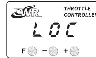
設定防盜功能後油門信號鎖定在怠速狀態無法正常加速行駛。
